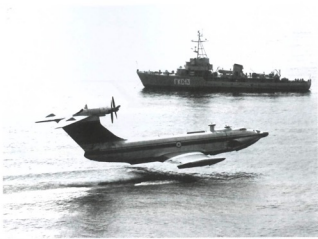
正在贴海面飞行的苏联“小鹰”号地效飞行器
