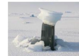
(b) 美核潜艇指挥室围壳破冰 图11 指挥室围壳上的冰块 Fig.11 The ice piece on submarine conning tower
